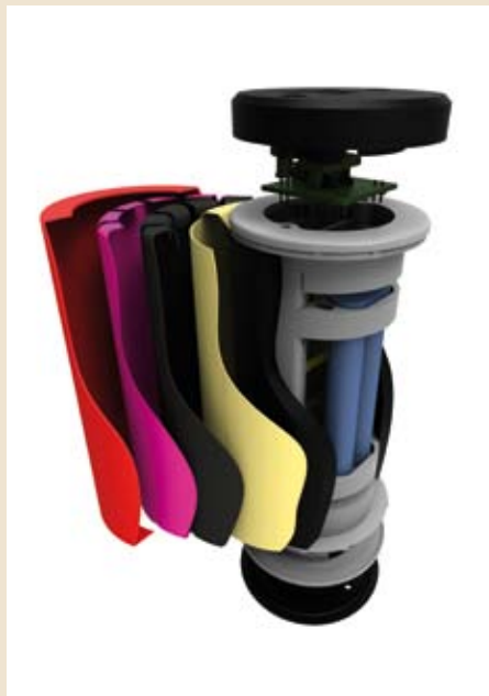
Abb. 2 Schnitt durch den Sensor
